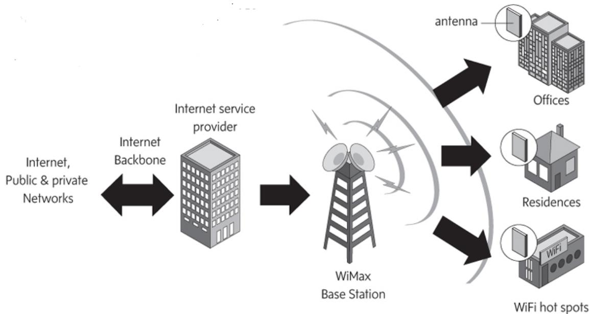
**Fig: Wi-Max operation<sup>20</sup>**
